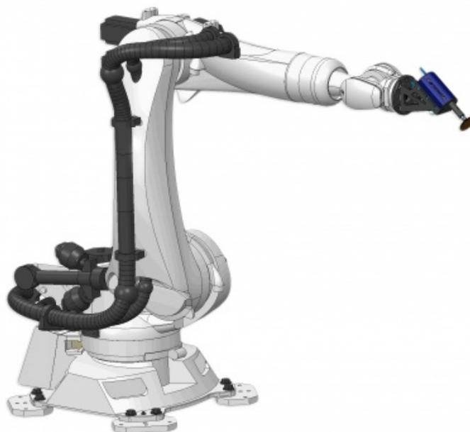
Abb. 27: Die Zeichnung des Schleif-Roboters
