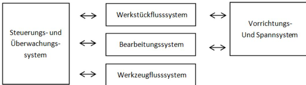
Abb. 2: Elemente eines FFS und deren Wechselwirkungen(1)
