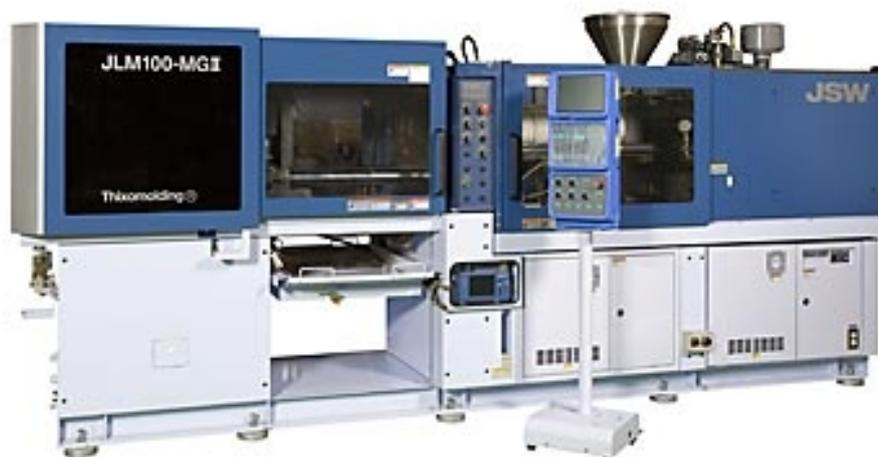
Abb. 12: Die Thixomoldingmaschine vonJS
