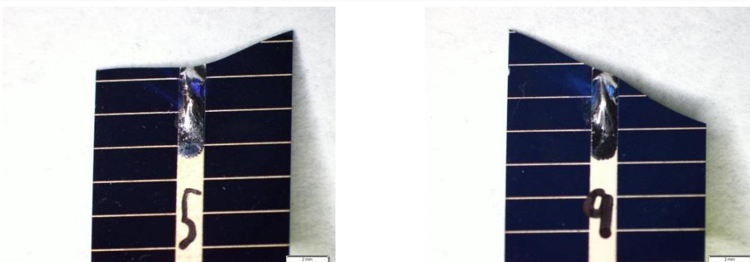
Abb. 19 Referenzproben der Vorderseite nach Benetzungstest
