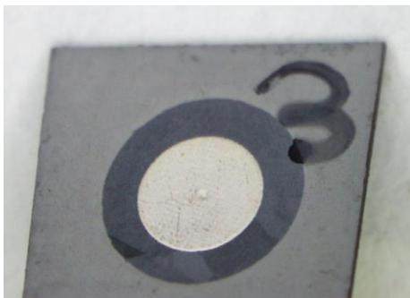
Abb. 62 Benetzungsergebnis nach den Messungen JA Solar bleifrei X3210i 250 °C
