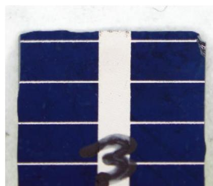
Abb. 50 Benetzungsergebnis nach den Messungen Sunways SnAgCu X3210i 250 °C
