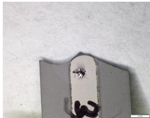
Abb.17 Referenzproben der Rückseite nach Benetzungstest
