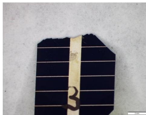
Abb. 34 Benetzungsergebnis nach den Messungen Q-Cells SnAg 396-DRX+ 250 °C
