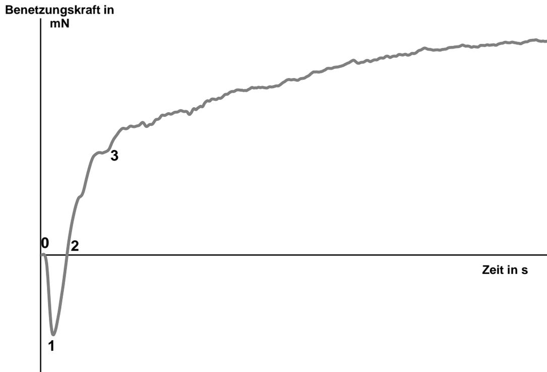
Abb. 07 Typischer Benetzungskraftkurvenverlauf mit den charakteristischen Stadien (0-3) der Probenbenetzung
