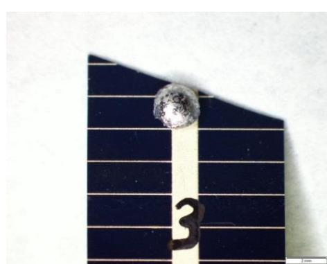
Abb. 25 Benetzungsergebnis nach den Messungen Q-Cells SnAgCu X3210i 235 °C
