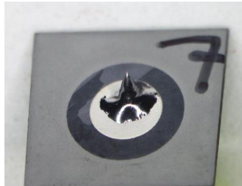
**Abb. 59** Benetzungsergebnis nach den Messungen JA Solar SnPbAg X3210i 235 °C
