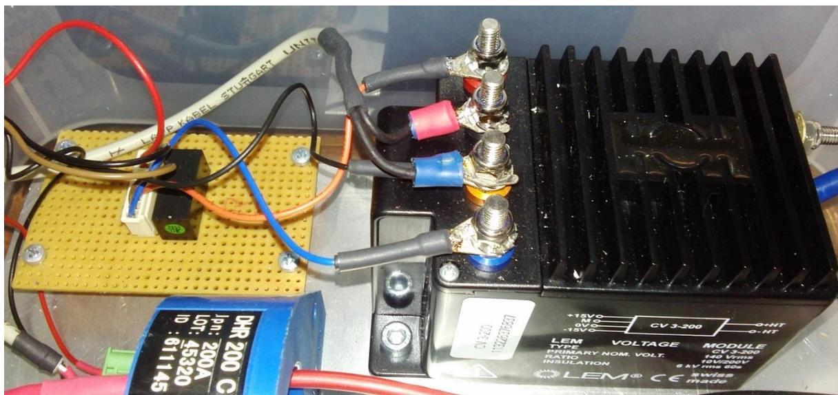
Abbildung 7: Spannungswandler CV3-200
