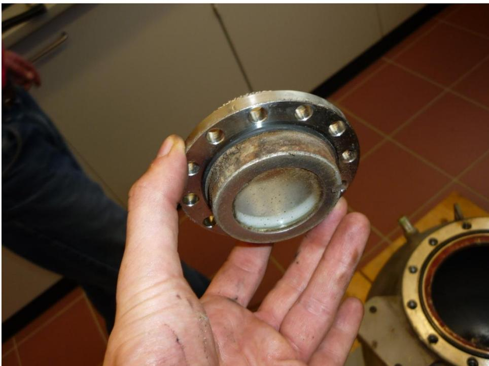
Der Staubvorlagebehälter wurde mit angeschlossenem Magnetventil entfernt und die Rohkugel konnte von der Befestigung am Untergrund gelöst werden.
