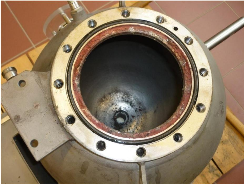
An der Abbildung erkennt man deutlich die Rußeinlagerungen der Staubexplosionen in den Zwischenräumen bei den Anschlüssen der Kugel. Diese Verunreinigungen wurden gesäubert und die Dichtung durch eine neue ersetzt.
