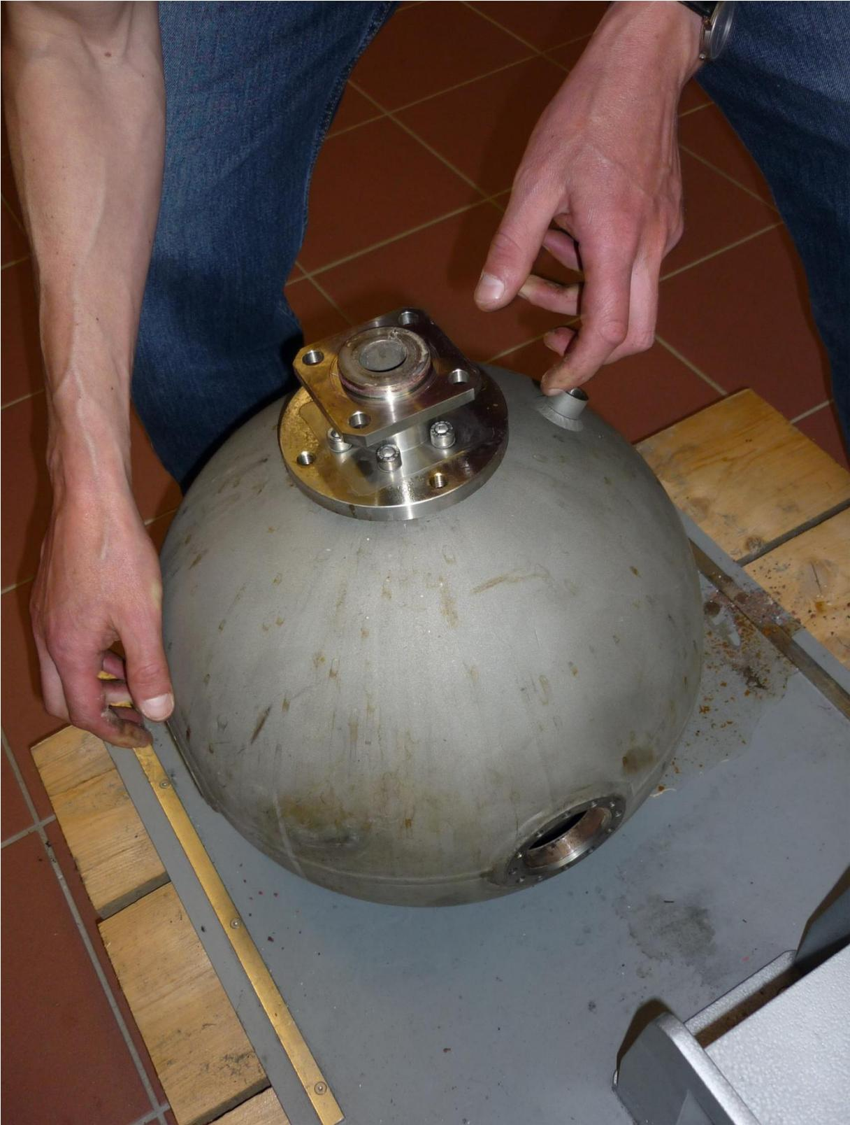
Die Kugel wurde mit Aceton und destilliertem Wasser von innen und außen gereinigt.
