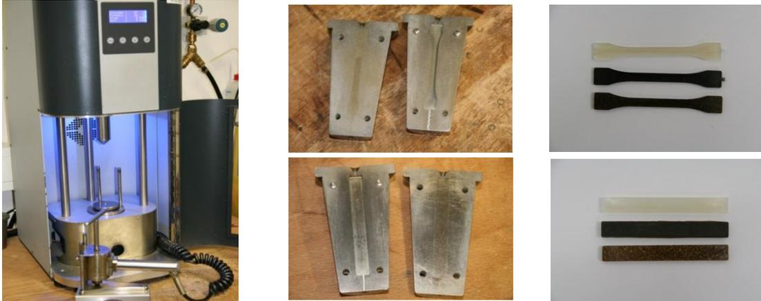
Abb. 33. Laborspritzgießmaschine „Haake MiniJet“ (links), die Formteile (mitte) und die Prüfkörper (rechts).
