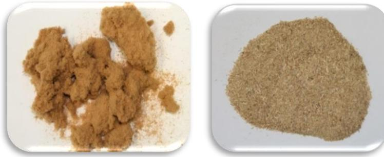
*Abb. 29. Darstellung von Buchenholzfasern unterschiedlicher Morphologie. Buchenholz-Refinerfasern (links); Buchenholzspäne (rechts).*
