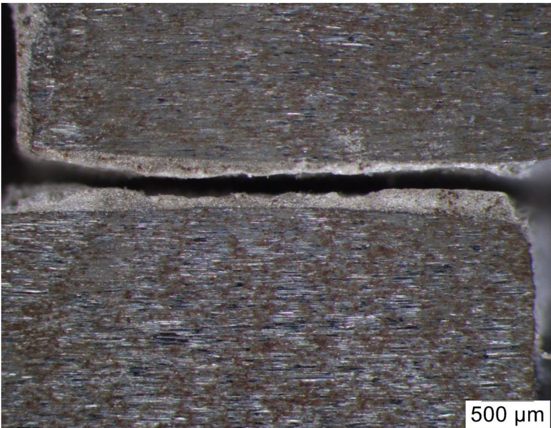
Abbildung 93: Bruchbild seitlich Probe\_H3
