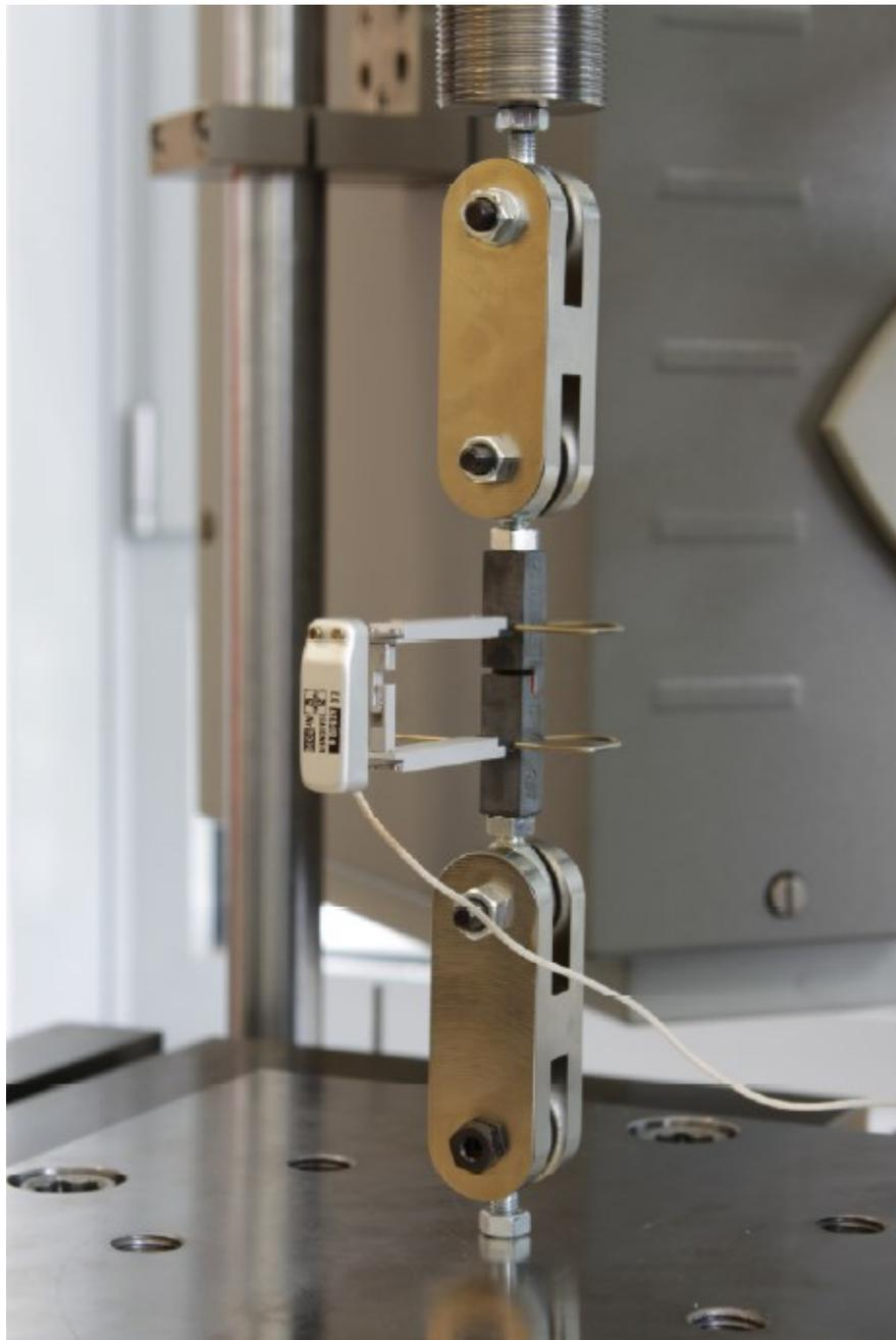
**Abbildung 33: Kardanische Gelenkkopflagerung /ALT10, S.13/**
