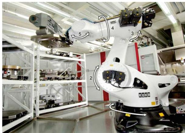
Abb. 36: Werkstückhandling zur Beschickung einer Fräsmaschine mittels Knickarmroboter; Quelle: Hermle, Kuka
