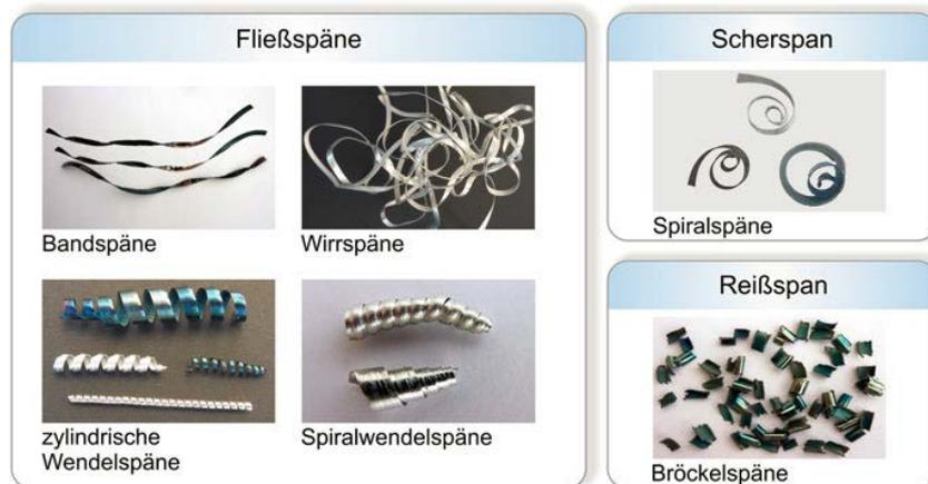
Abb. 19: Spanformen geordnet nach den Spanarten; Quelle: Werkzeugmaschinen Aufbau, Funktion und Anwendung vonspanenden und abtragenden Werkzeugmaschinen, Springer
