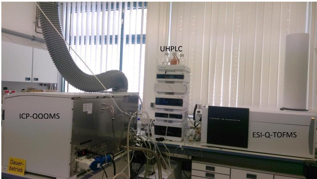
**Abbildung 4: Verwendete Geräte zur Kopplung von Chromatographie mit ICP-MS und ESI-MS**
