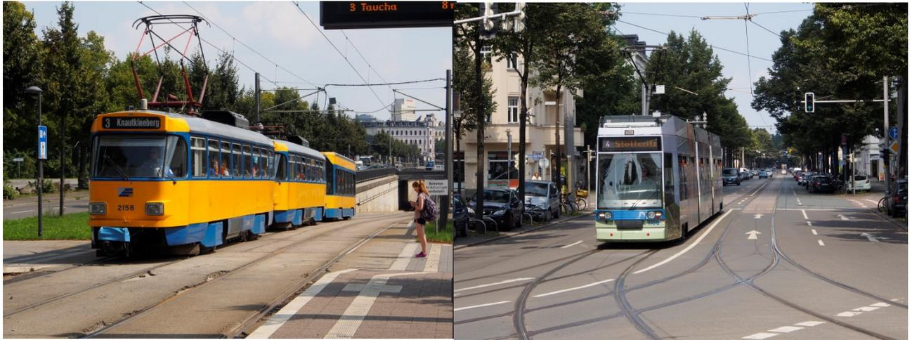
Abbildung 2 Fahrzeugtypen T4D-M & NGT8
