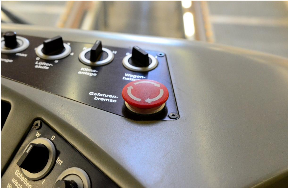
Abbildung 46 Pilztaster Gefahrenbremse im Führerstand
