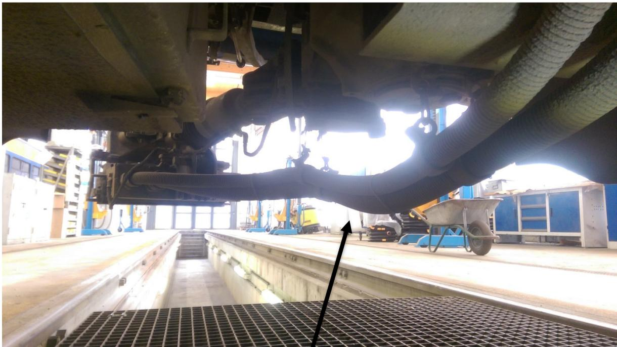
Kabelstränge von/zur der Kupplung
