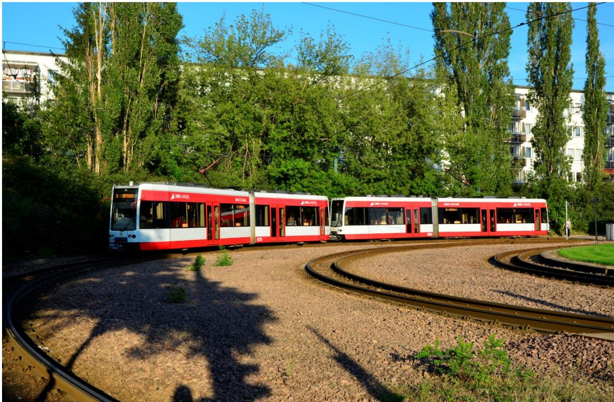
Abbildung 14 MGT-K Halle (Beispiel für einen Anderthalbrichter)
