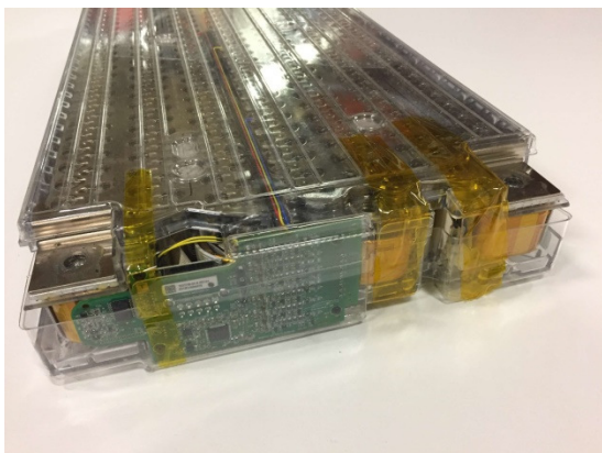
Bild 5: Modul der Firma Tesla mit Schraubkontakten zur Anbringung einer Kupferformschiene (nach [3])
