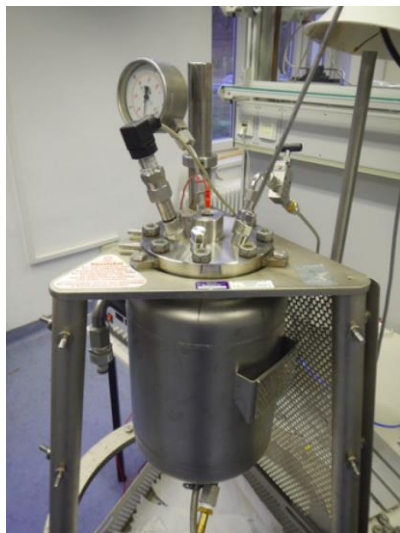
Bild 3: Versuchsaufbau: Reaktionsbehälter (links) und Schema (rechts) [3]
