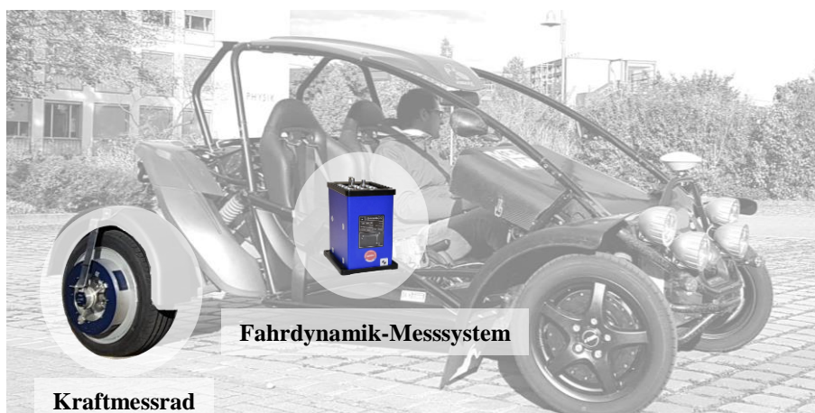
Abbildung 2: Versuchsfahrzeug BugEE mit Sensorik
