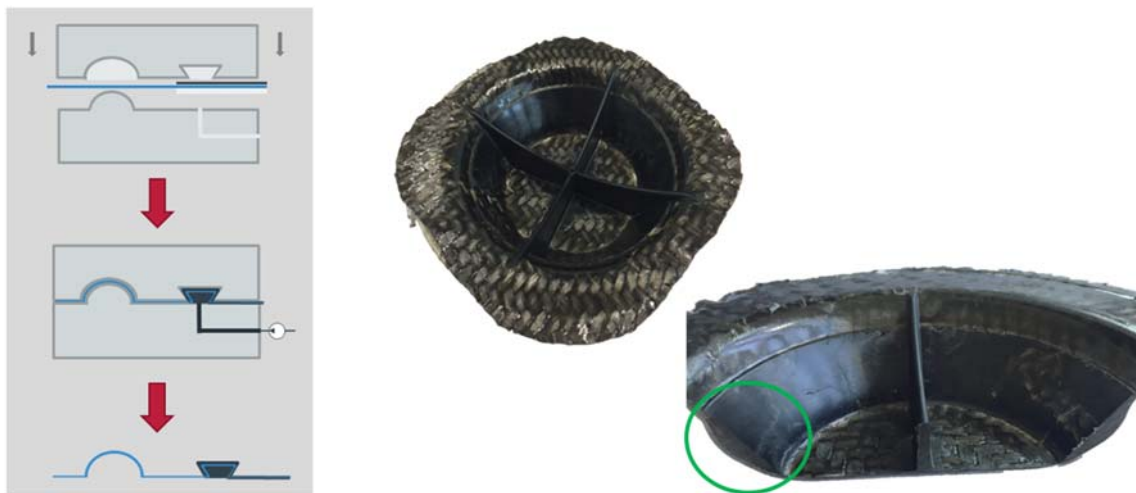
Bild 8: Schematische Darstellung des Herstellungsprozesses (links), Hybridnapf aus Vorversuch mit Hinterschnitt (rechts)
