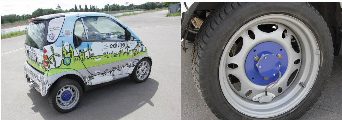
Bild 6: Messrad mit Telemetrie System GSV-6BT an Editha 1.0
