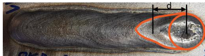
Bild 3: Ermittlung des Abstandes d zwischen Drahtelektrode und Thermoelement
