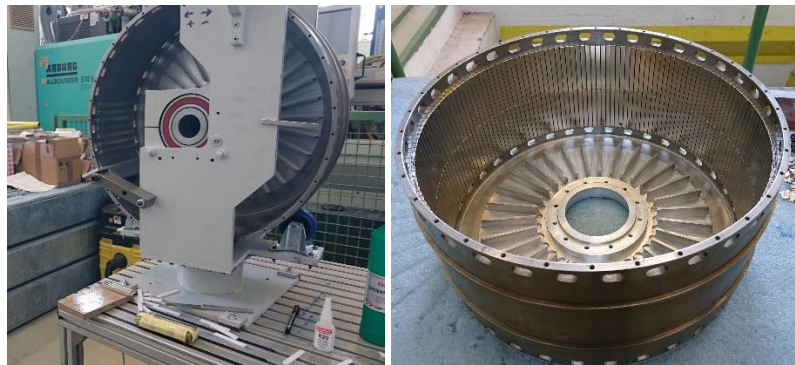
Bild 9: Magneten einkleben (links), doppelreihig geklebte Magneten im Rotor mit Deckel (rechts)
