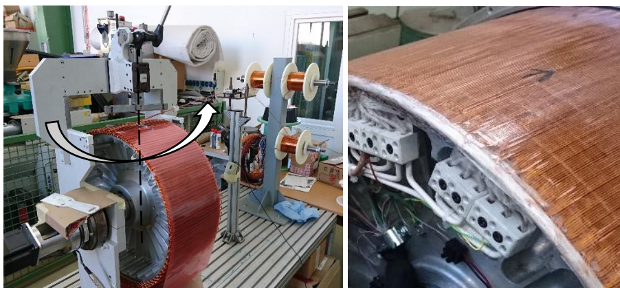
Bild 8: Aufkleben der Luftspaltwicklung (links), Vollständige Kombinationswicklung (rechts)
