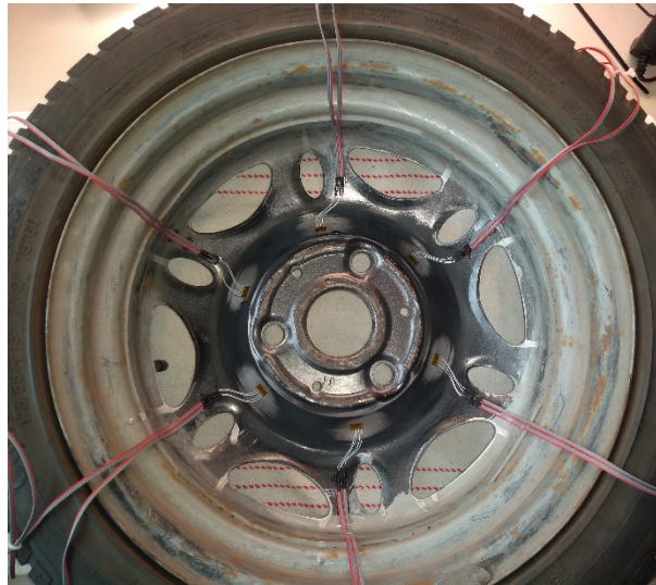
Bild 3: Applikation der DMS auf dem Felgenkörper
