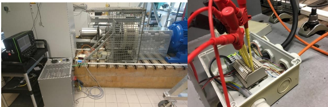
Bild 7: Prüfstandsmessung am Wassergenerator
