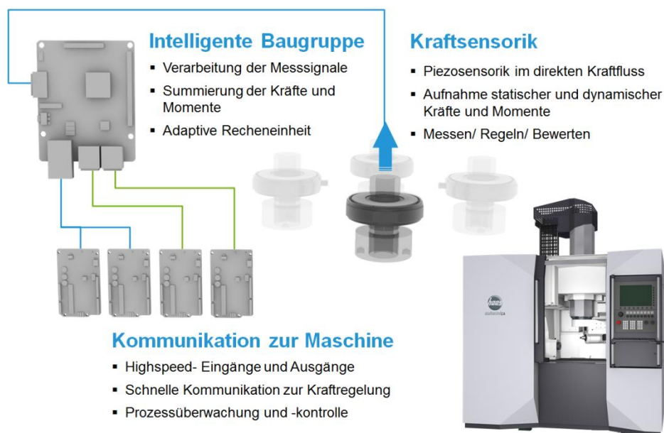
Bild 4: Kraftsensorik als wesentliche Voraussetzung für die KombiFin-Technologie
