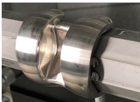
Bild 9: bearbeitete Seitenwand (links), Geradheitsabweichung nach der Finishbearbeitung
