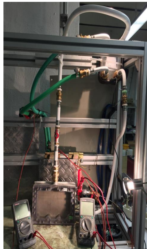
Abb. 2: Links ist der schematische Aufbau der kombinierten Siede-Wasserkühlung im Naturumlauf dargestellt. Eine Heizplatte, montiert auf das Siedemodul, erzeugt die Heizleistung entsprechend der Verlustwärme P_Q eines Bauteils. Der Siedeprozess kann durch ein Sichtfenster beobachtet werden. Während des Betriebs werden die Temperaturen der Heizplatte T_H , des Siedemoduls T_S , des Fluids SES36 T_{\text{SES36}} und die Wassereintrittstemperatur T_W aufgenommen, siehe rote Punkte. Das Bild rechts zeigt eine Fotografie des Teststandes.
