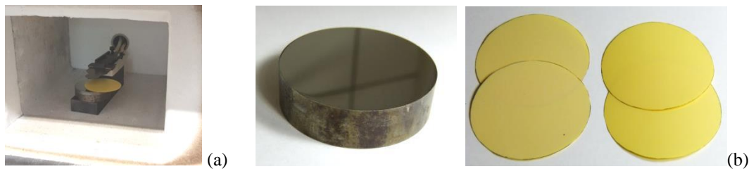
Bild 5: Ofen mit eingebautem Sensor für Hot-Disk-Messungen (a); die Dünnschichtproben zur Messung der Wärmeleitfähigkeit von Elektroisolierklebefolien (b)
