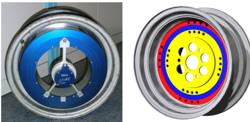
Bild 1: Felge mit Messadapter(blau)
