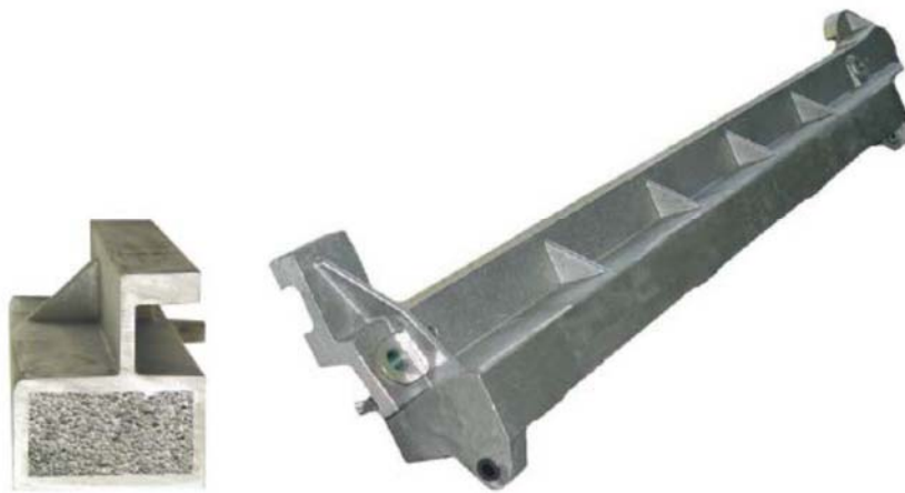
Bild 4: Mit Aluminiumschaum gefüllter Tragbalken einer Textilmaschine (Serienprodukt)
