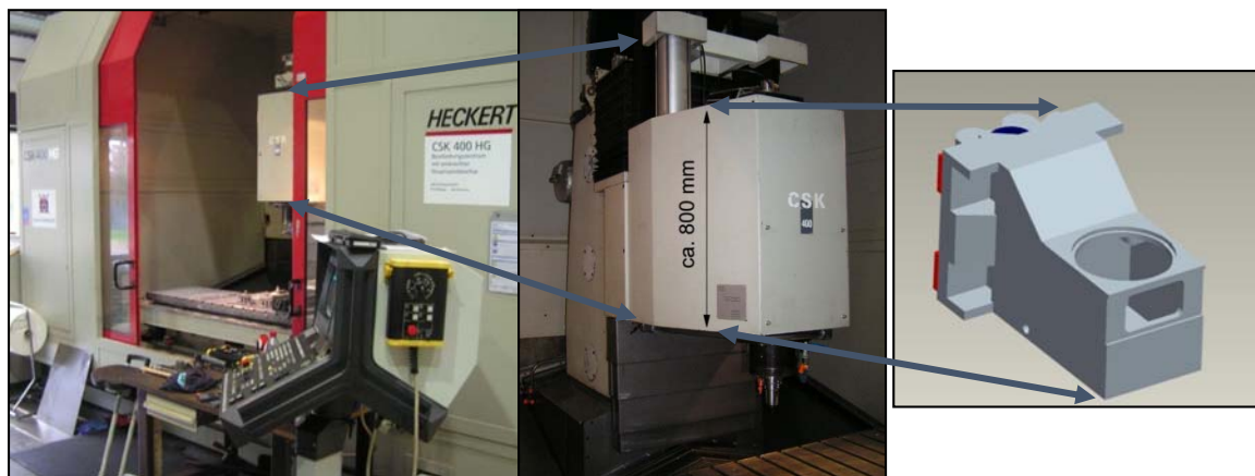
Bild 1: Werkzeugmaschinen-Baugruppe mit hochdämpfendem Sandwich-Kern
