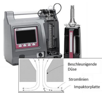
Bild 13: Aufbau/Funktion eines (elektrischen) Niederdruck-Kaskadenimpaktors [6]
