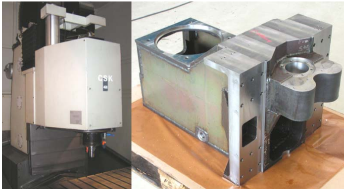
Bild 3: Ausgeschäumter z-Schlitten eines Senkrecht-Fräszentrums
