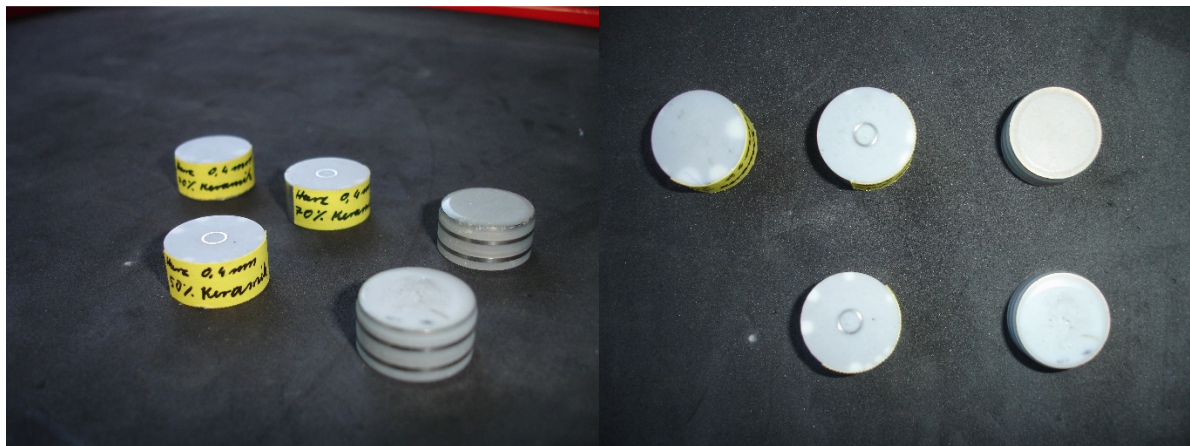
Bild 4: Messproben für die Impedanzmessung (links: Messproben aus Kathodenkörper und Isolierstoff aus Harz und Keramikmehl; rechts: Draufsicht auf eine innere Kathode) [6]
