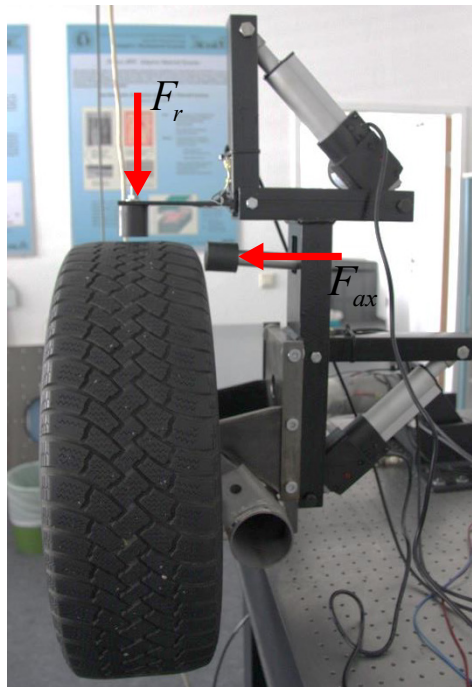
Bild 4: Belastungsprüfstand für axiale und radiale Kräfteinleitung
