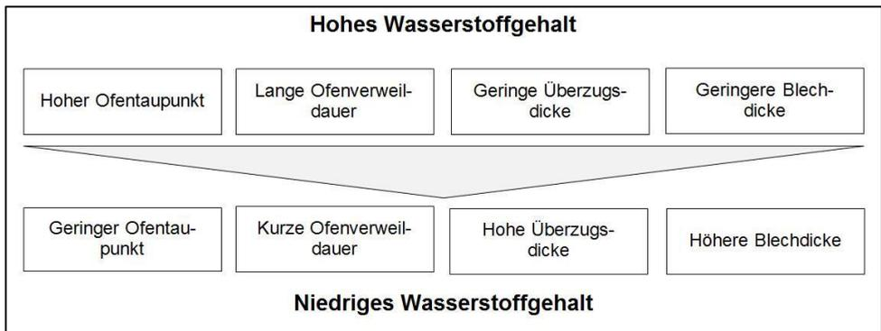
Abbildung 76: Übersicht über die Wasserstoffaufnahme beeinflussenden Prozessparameter beim Presshärten
