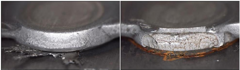
Abbildung 58: Blick auf Bruchflächen nach dem Zugversuch: duktiler Bruch durch den Härtesack (links), Kaltriss durch/entlang der Schweißlinse (rechts)
