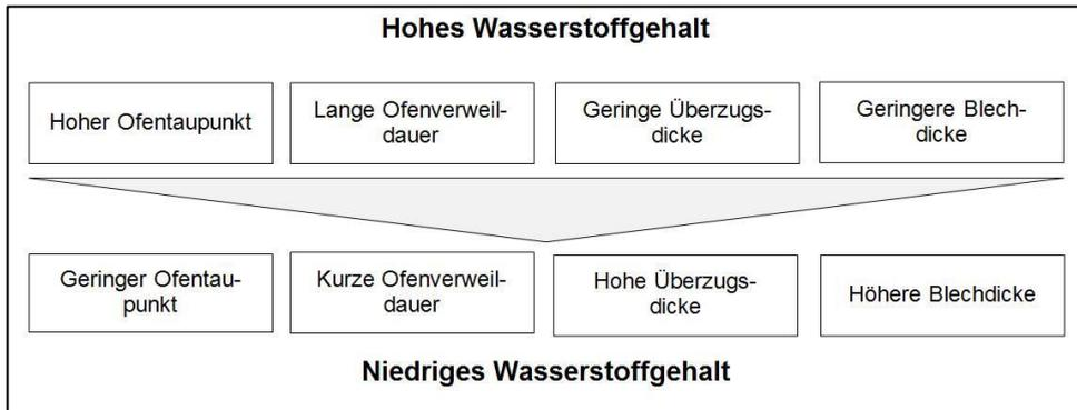
Abbildung 76: Übersicht über die Wasserstoffaufnahme beeinflussenden Prozessparameter beim Presshärten
