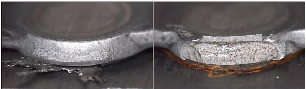
Abbildung 58: Blick auf Bruchflächen nach dem Zugversuch: duktiler Bruch durch den Härtesack (links), Kaltriss durch/entlang der Schweißlinse (rechts)
