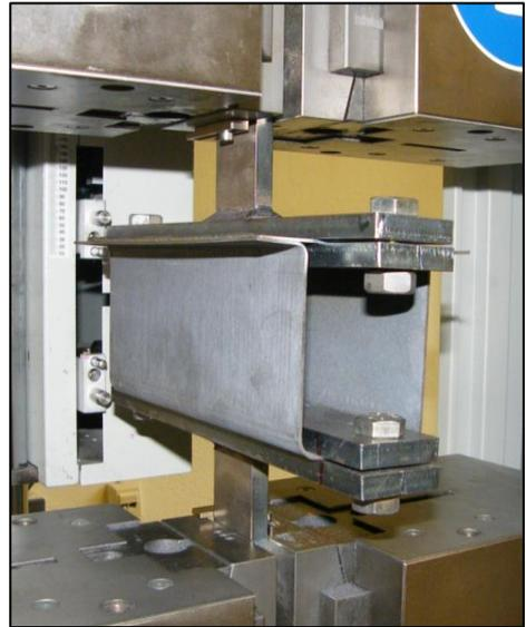
Abbildung 74: Abzugprüfung für Demonstratorbauteile
