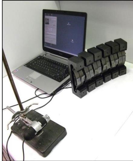
Abbildung 44: Opto-temporäre Rissdetektion
