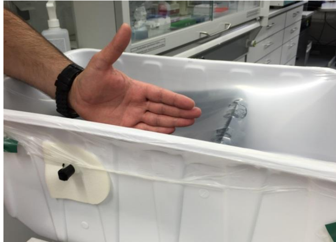
Abb. 6: Dichtigkeitsversuch ohne Organ; trotz sichtbarer Einsenkung keine Luftdichtigkeit
