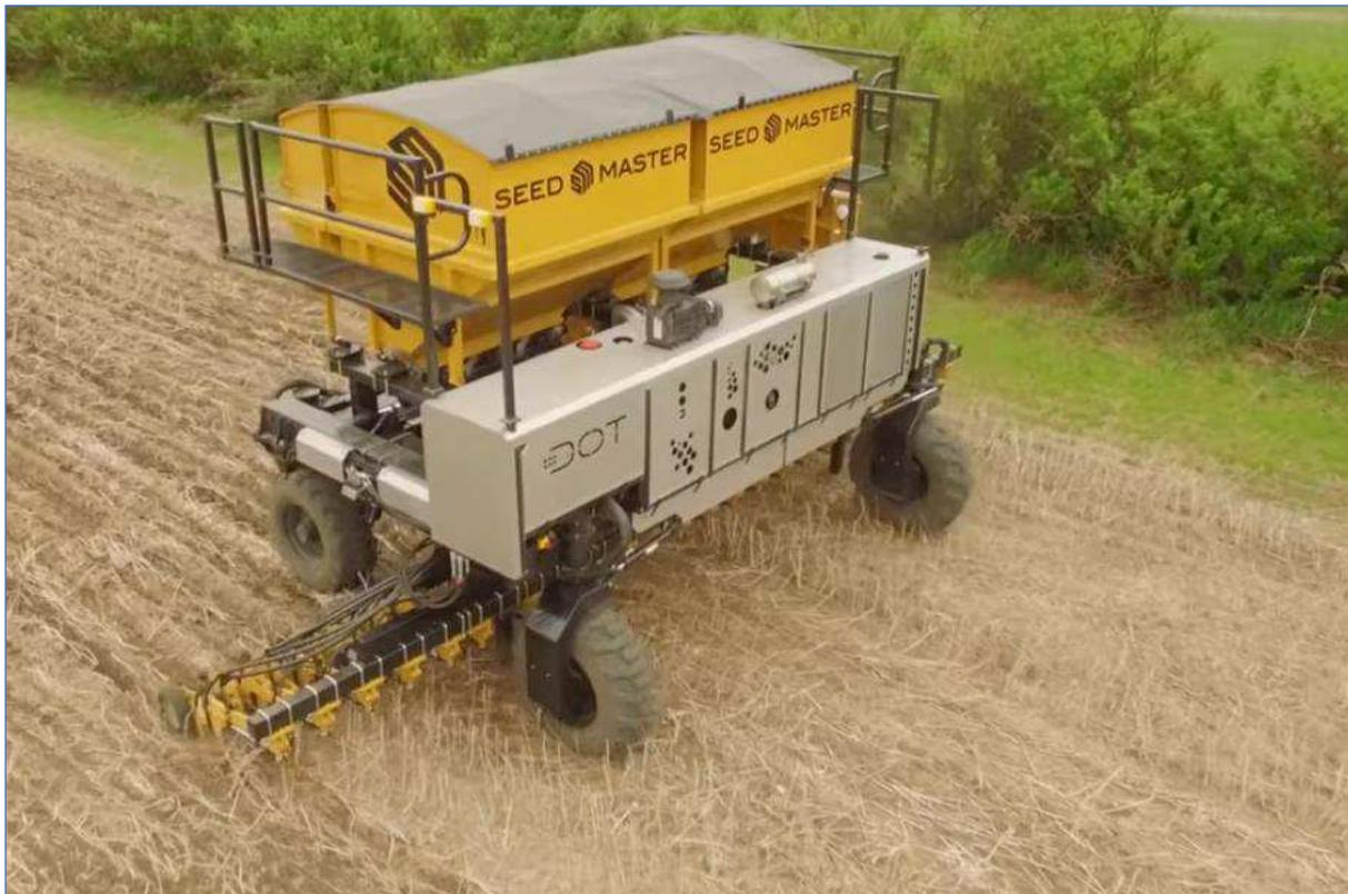
Abbildung 41: Roboter DOT auf dem Weg zur Aufnahme der Drillmaschine (Filmausschnitt: DOT, 2019)
