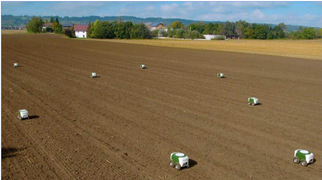
Abbildung 44: Acht Einheiten des FENDT Xaver auf einem Schlag bei der Maissaat (BR Fernsehen, 2017)
