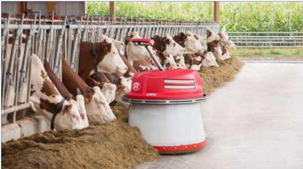
Abbildung 39: Roboter zum Anschieben des Futters (LELY 2019)
