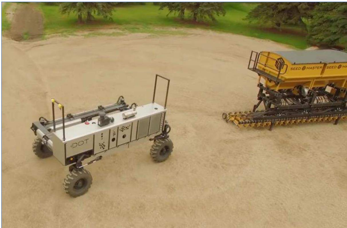
Abbildung 42: Autonomes Trägersystem DOT bei der Aussaat auf dem Feld (Filmausschnitt: DOT, 2019)
