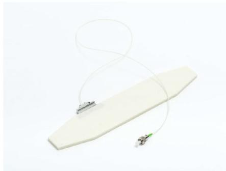
Anordnung und Integrationsmethodik für eine eingebettete faseroptische Schnittstelle zur Anwendung in dünnwandigen, polymeren Strukturen und Bauteilen
