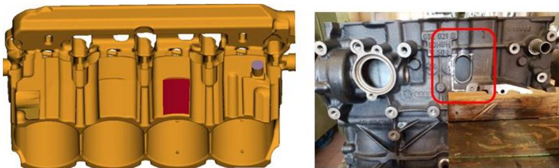
**Abbildung 3-6: Fenster 1: Zugang für PIV-Messungen**
