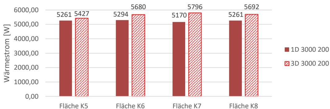
**Abbildung 6-16: Wärmeströme Teilflächen Zylinderkopf heiße Seite hoher Betriebspunkt**
