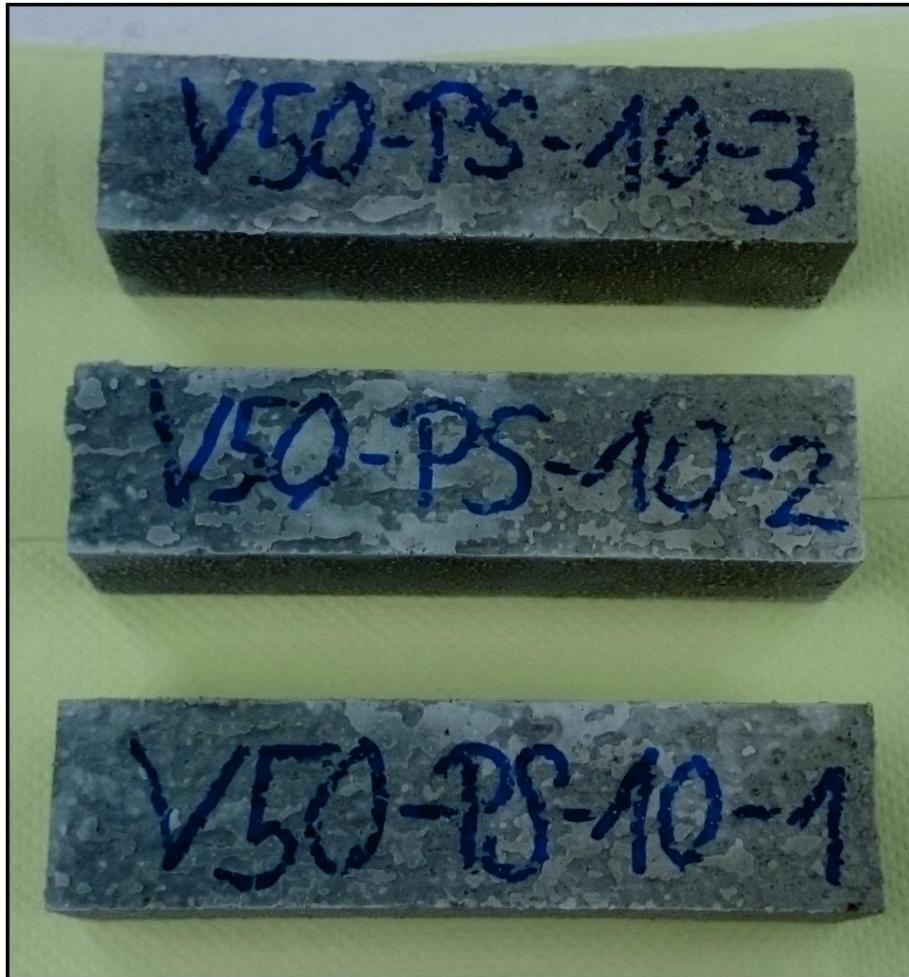
**Abbildung 14:** Gemäß der Deutschen Norm DIN EN 196-1:2005 (2005) hergestellte Mörtelnormprismen.
