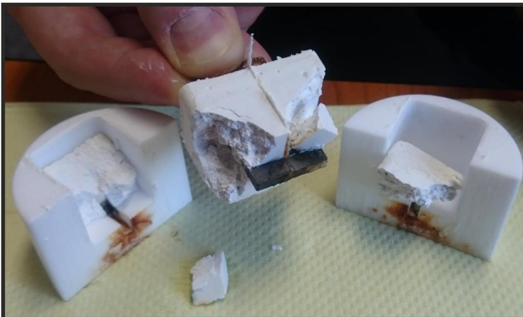
**Abbildung 62:** Entschalung einer Stahl-Wollastonit-Verbundprobe.
