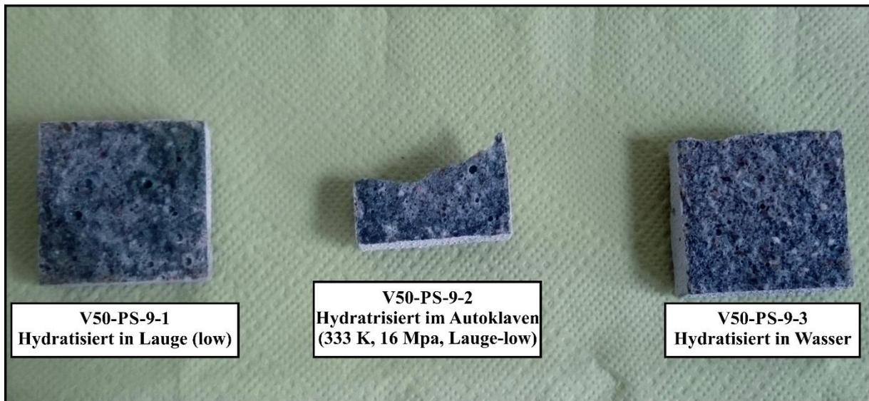
**Abbildung 30:** Bruchstücke aus den Zentren der Mörtelnormprismen (V50-PS-9-1, V50-PS-9-2, V50-PS-3) nachdem die Druckfestigkeit festgestellt wurde. An diesen Bruchstücken wurde die Mikrostruktur untersucht (Svensson et al. 2018b).
