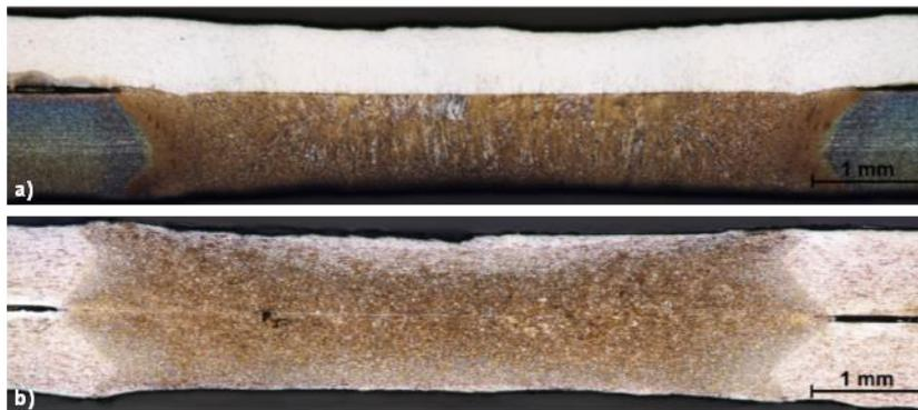
Abbildung 1: Querschliff von KE-Schweißungen ohne erkennbare Schweißlinse; a) DX 57D (0,7 mm) – HCT 980C (1 mm), b) HX 260 (0,8 mm) – HX 260 (0,8 mm)
