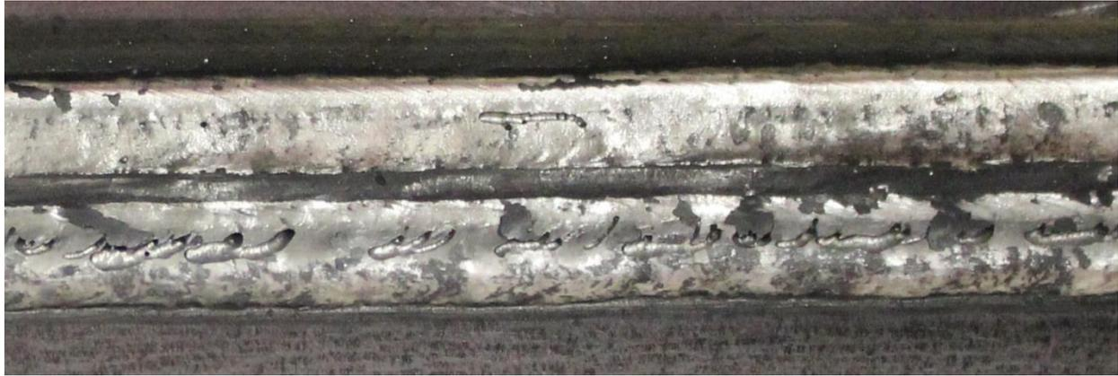
Bild 52: Poren im Schweißgut des Fülldrahtes T Ni 6625 P\*\* in Position PC beim Schweißen von X8Ni9
