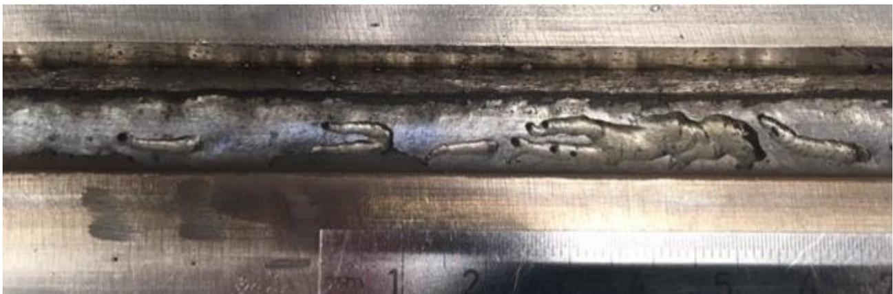
Bild 34: Beispiel für offene Schlauchporen mit Porenkanal in die Tiefe
