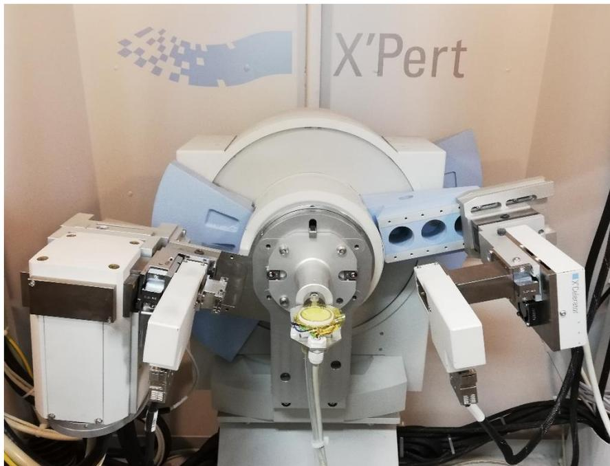
Abb. 4: X'Pert Diffraktometer mit MESICON Probenhalter und Temperaturregler
