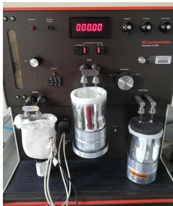
Abb. 7: BET-Gerät „Flowsorb II 2300“ von Micromeritics
