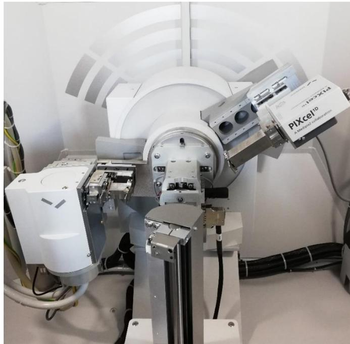
Abb. 2: X'Pert<sup>3</sup> Powder Diffraktometer der Firma PANalytical B.V. mit PIXcel<sup>1D</sup> Detektor
