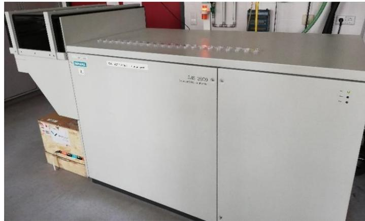
Abb. 5: Wellenlängendispersives Röntgenfluoreszenzspektrometer SRS 3000 von Siemens
