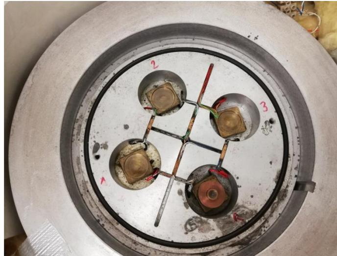
Abb. 8: Wärmeflusskalorimeter mit Vierlingsanordnung (drei Messzellen und eine Referenzzelle)
