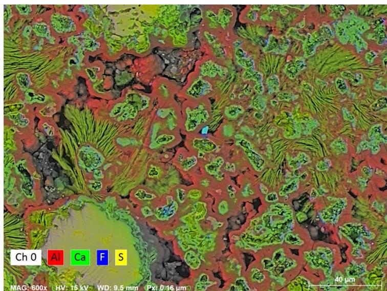
Abb. 59: Verteilung der Elemente Aluminium, Calcium, Fluor und Schwefel über die Fläche der hydratisierten Probe  $3\text{CaO}\cdot 3\text{Al}_2\text{O}_3\cdot 0,9\text{CaF}_2\cdot 0,1\text{CaSO}_4$ . Gestapelte Plättchen in grün:  $\text{C}_2\text{AH}_8$ , Säume in rot:  $\gamma\text{-Al}(\text{OH})_3$ , Füllung der Poren: fluorhaltiges  $\text{C}_3\text{AH}_6$
