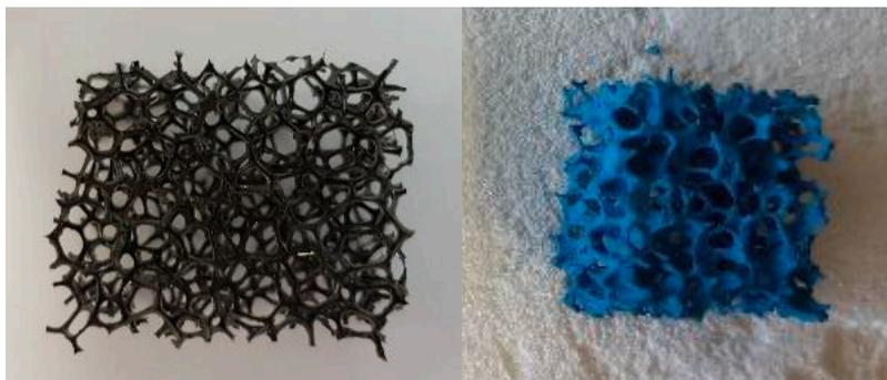
Abb. 5.6: Organisches Polymertemplat (links) und  $NiAl_2O_4$ -Replikat aus der Formgebung mittels Replikationsverfahren.
