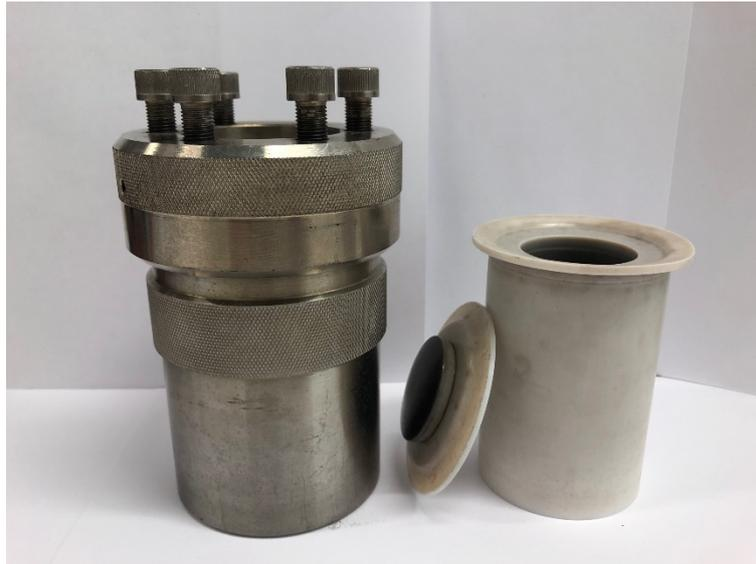
Abb. 3.1: Stahlautoklav und Teflonhülse für die solvothermale Behandlung der PBA.
