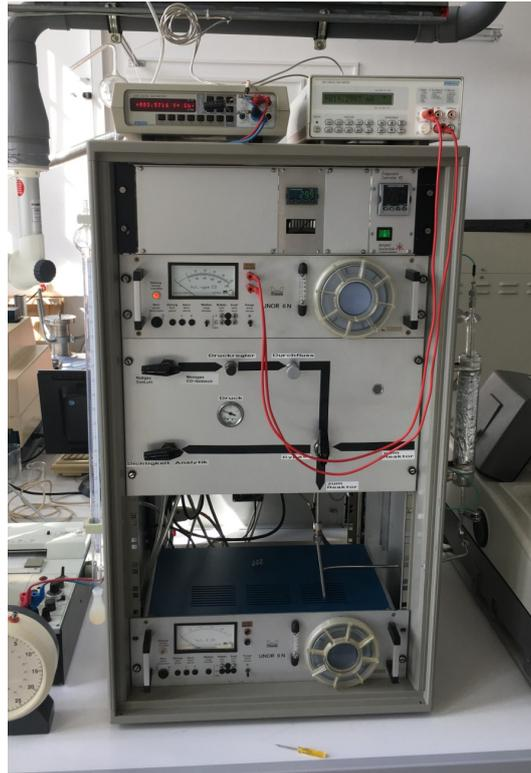
Abb. 3.4: Anlage zur Untersuchung der katalytischen Oxidation von CO.
