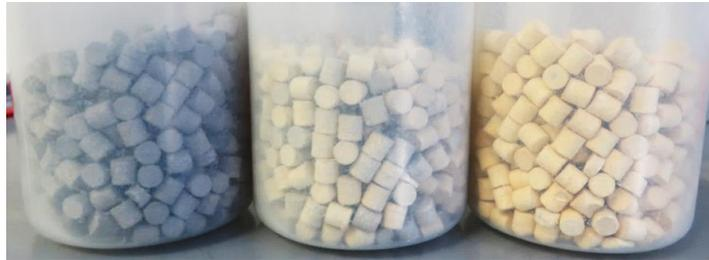
**Abb. 55:** Optische Veränderung des Katalysators durch Kalzinieren bei 250 °C, 350 °C und 450 °C (von links nach rechts)
