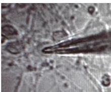
**Abb. 4: Patch-Clamp-Messung.**
