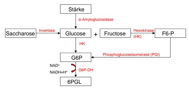
Abb. 7: Prinzip der enzymatischen Kohlenhydratbestimmung.
