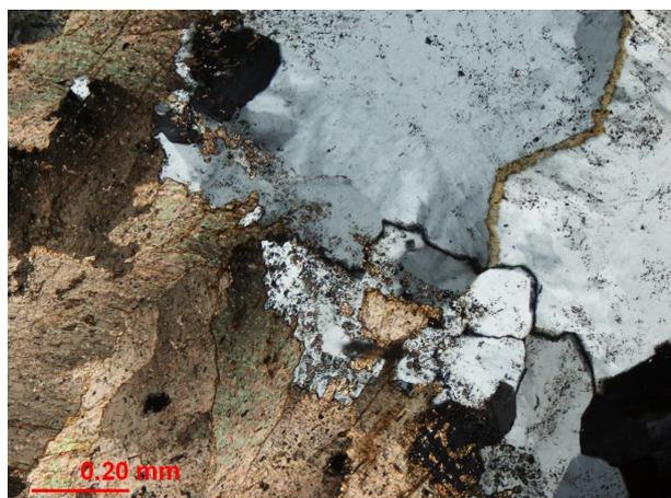
Abb. 5.1.14: Dünnschliff der Probe Biw-1. Quarz (grau) durchschlägt und verdrängt Siderit (braun).
