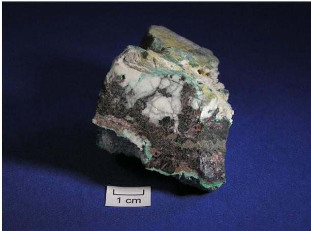
Abb. 5.1.109: Foto der Probe EmsF-1 mit Sphalerit, Chalkosin (dunkel), Cuprit, ged. Cu (rötlich), sowie Quarz und Malachit.
