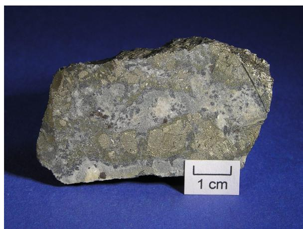
Abb. 5.1.158: Foto der Probe Radz-3. Gut erkennbar sind v. a. die blassgelben Pyrit-Aggregate.
