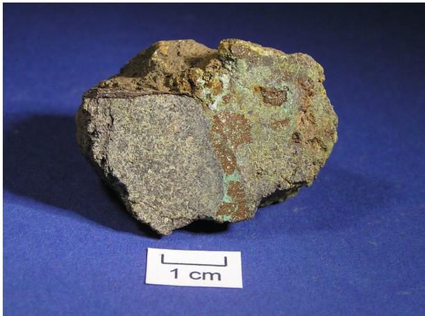
Abb. 5.1.75: Foto eines Stückes der Probe Engl-1 mit Nebengestein (v. a. links) und Vererzung auf unregelmäßigen Äderchen (rechte Hälfte des Stückes)
