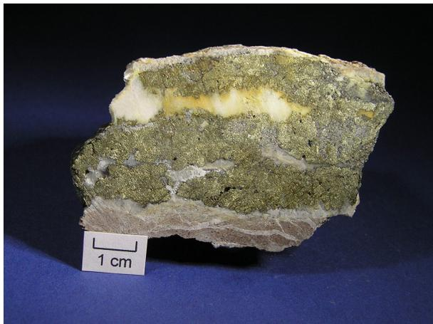
Abb. 5.1.91: Foto der Probe Donsb-1. Die Sägefläche zeigt Chalkopyrit, Pyrit und weiße Gangart, sowie oben und unten rötliches Nebengestein.
