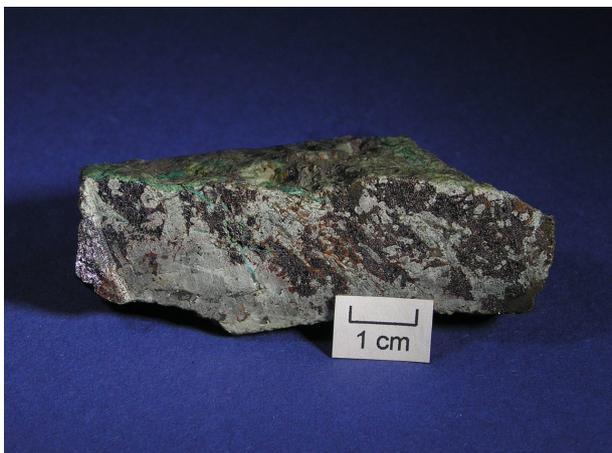
Abb. 5.1.152: Foto der Probe Mied-3 mit gut erkennbaren Bornit-Aggregaten (dunkel bis violett) auf der Sägefläche.
