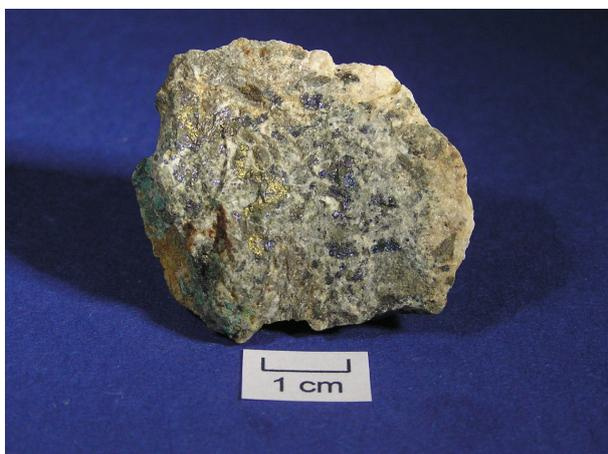
Abb. 5.1.24: Stück der Probe Sie-1 mit Chalkopyrit (gelb) und Bornit (blauviolette Anlauffarbe).
