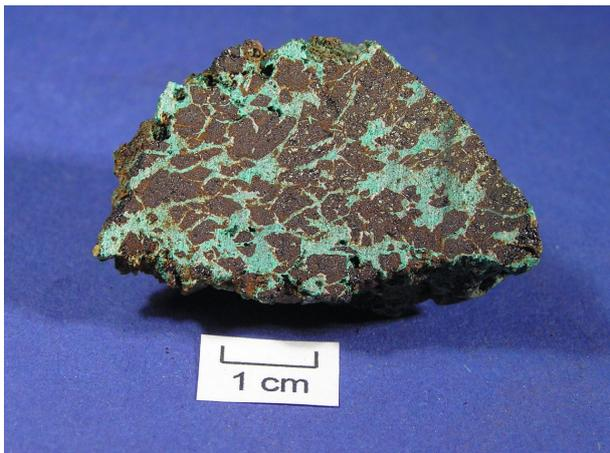
Abb. 5.1.34: Foto der Probe Kyf-1 mit Malachit (grün) und größtenteils zu Limonit verwitterten Chalkopyrit-Aggregaten.
