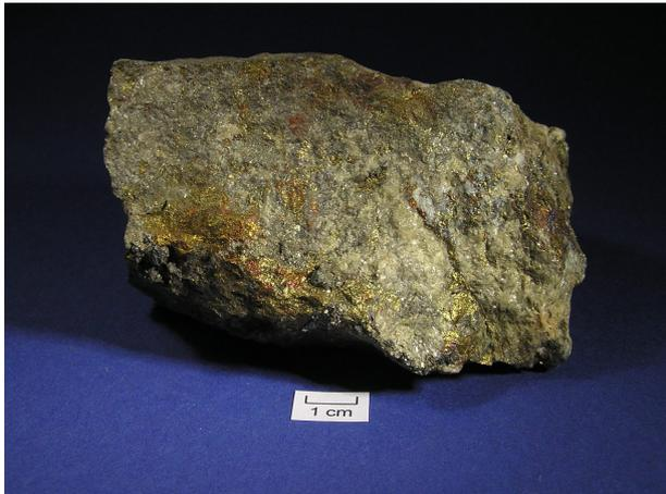
Abb. 5.1.97: Foto der Probe Eiserf-1 mit Chalkopyrit (gelb, leicht angelaufen) in Siderit (beige).
