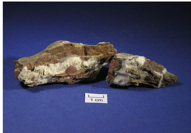
Abb. 5.1.23: Foto zweier durch Hämatit rot gefärbter Stücke der Probe TrtL-2 mit weißen Kalzit-Chalkopyrit-Äderchen.
