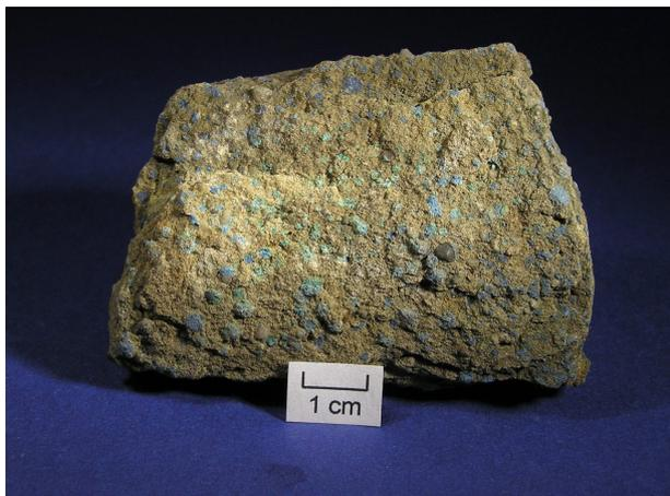
Abb. 5.1.45: Foto der Probe CuSKyf-1. Auf den Schichtflächen sind Malachit- und Azurit-Aggregate zu erkennen.
