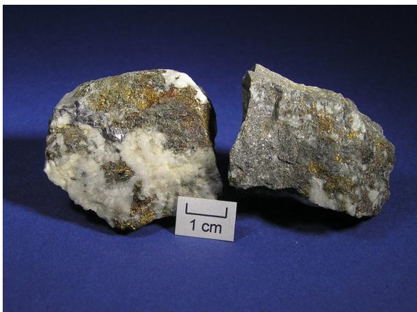
Abb. 5.1.103: Zwei Stücke der Probe Hlz-1, v. a. aus weißem Quarz, Chalkopyrit (gelb), Galenit und Sphalerit. bestehend.
