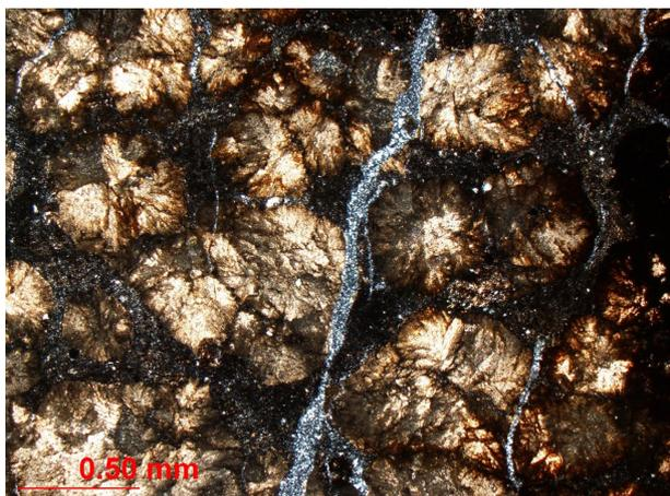
Abb. 5.1.83: Rundliche Siderit-Aggregate in feiner Matrix durchschlagen von einem Quarz-Äderchen (Durchlicht).
