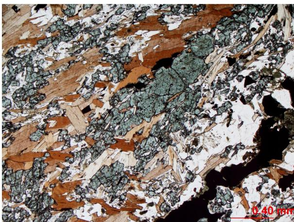
Abb. 5.1.142: Nebengestein der Probe Bod-2 im Dünnschliff (Durchlicht, Hellfeld) mit Biotit (braun), Kreittonit (grün) und Feldspat (farblos), sowie Erzminerale (opak).
