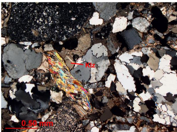
Abb. 5.1.48: Nebengestein in Probe CuSEp-1 mit Quarz, Geröllen (z.B. rechts Quarzit) und Kalzitcement (Klz) (Durchlicht).
