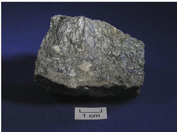
Abb. 5.1.57: Stück der Probe Kam-1, welches v. a. aus Fahlerz besteht (grau, Metallglanz).
