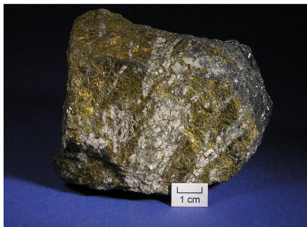
Abb. 5.1.118: Foto der Probe Wer-2 mit Chalkopyrit (gelb), teils auf Äderchen in Karbonat (Mitte), und Galenit (rechts).
