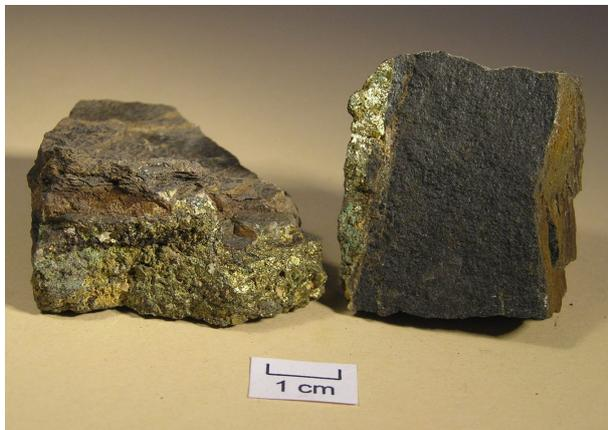
Abb. 5.1.22: Foto von zwei Stücken der Probe TrtL-1 mit Chalkopyrit-führenden Äderchen (gelb).
