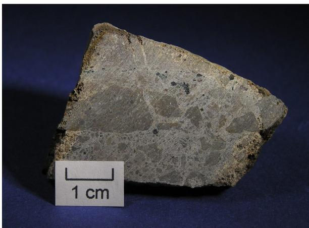
Abb. 5.1.123: Foto der Probe Gies-1 mit Nebengesteinsklasten und Bornit-Chalkosin-Aggregaten (dunkel).
