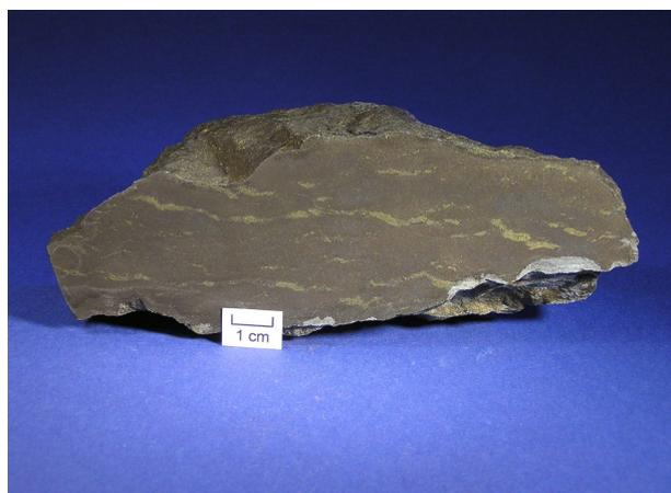
Abb. 5.1.146: Foto der Probe Sohl-1 mit Chalkopyrit-„Flasern“ in Pyrrhotin (bräunlich angelaufen).
