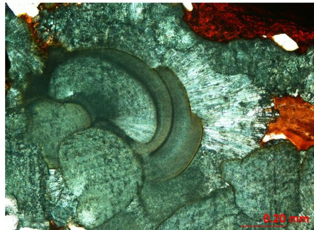
Abb. 5.1.35: Dünnschliff der Probe Kyf-1 mit Limonit und traubig-nierigem Malachit (Durchlicht).
