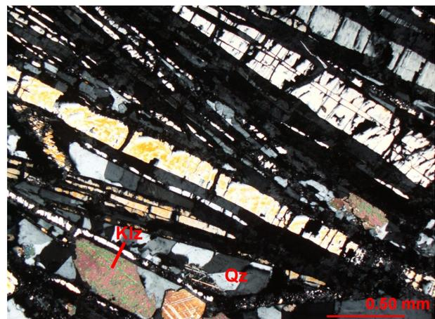
Abb. 5.1.28: Dünnschliff der Probe Laut-3 (Durchlicht): Gips bzw. Anhydrit (nadelige Kristalle), Kalzit (Klz) und Quarz (Qz).
