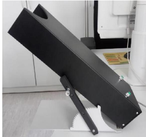
Abbildung 13: : Gerät zur Ermittlung der Flimmerverschmelzungsfrequenz
