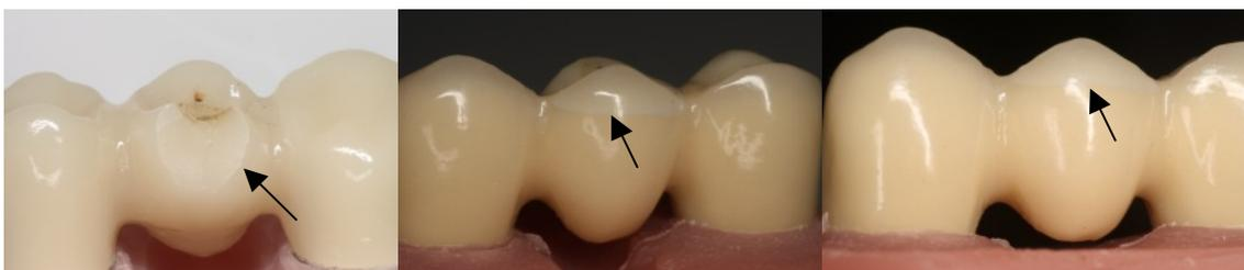
**Abb. 26: a Höckerfraktur e.max CAD (links); b Riss in überpresster Verblendung (Mitte); c Riss in geschichteter Verblendung (rechts) (durch Pfeile gekennzeichnet)**
