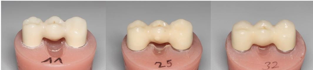
**Abb. 11: Brücke aus  $LS_2$  (links), überpresstem  $ZrO_2$  (Mitte) und überschichtetem  $ZrO_2$  (rechts) in Kunststoffhalterung nach Kausimulation**
