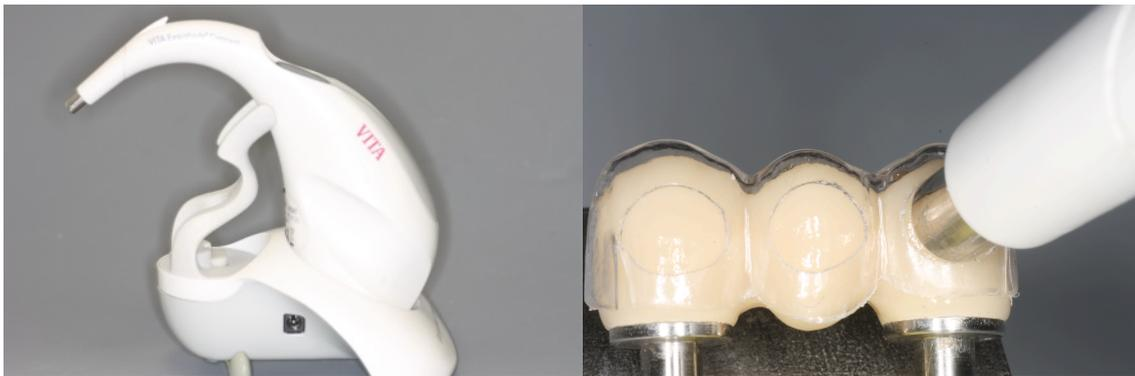
**Abb. 14: Spektrophotometer Vita Easyshade (links) und Farbmessung an Brücke mit aufgesetzter Schablone (rechts)**
