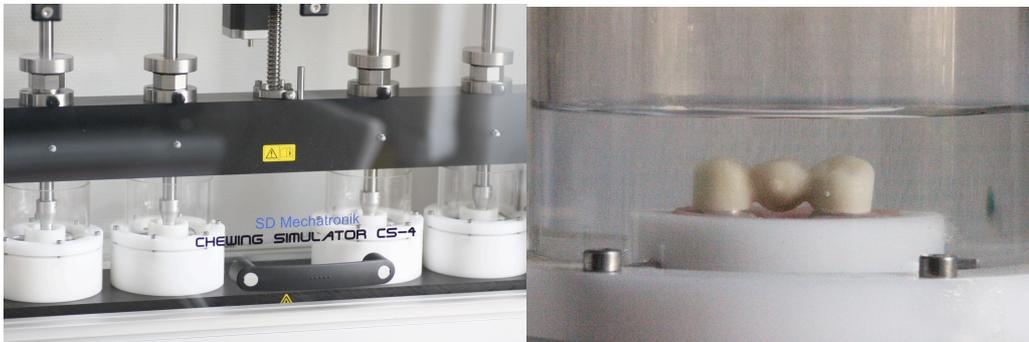
**Abb.15: Kausimulator (links), überpresst verblendete  $ZrO_2$ -Brücke im Kausimulator mit Speichelbad (rechts)**
