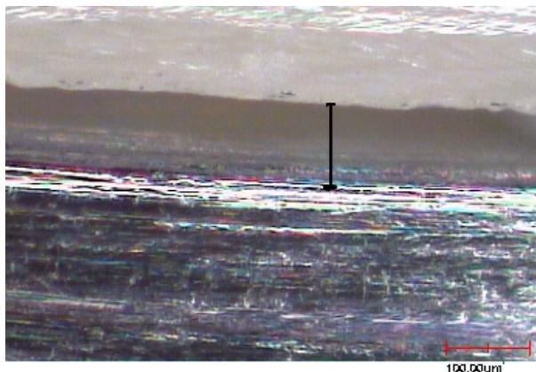
Abb. 13: Randspalt bei 560-facher Vergrößerung
