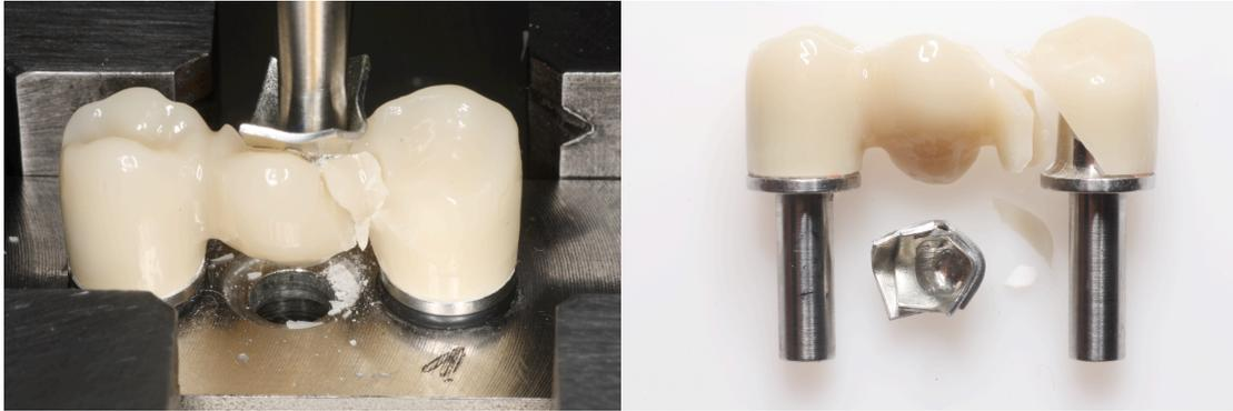
**Abb. 16: Bruchlasttest einer dreigliedrigen Brücke in der Universalprüfmaschine (links) und zerstörte überschichtete ZrO<sub>2</sub>-Brücke nach Bruchlasttest (rechts)**
