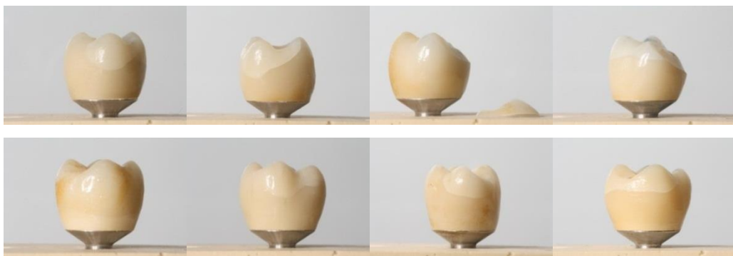
Abb. 22: Nach der Thermozyklisierung beschädigt vorgefundene Kronen. Oben li.: BeCe PRESS (Infraktur distopalatinaler und -vestibulärer Höcker; oben zweite v.li.: BeCe PRESS (Infraktur distopalatinaler Höcker); oben zweite v.re.: Pulse MC Presskeramik (kohäsiver Bruch mesiovestibulärer Höcker); oben re.: BeCePRESS Z (Fraktur mesiopalatinaler Höcker); unten li.: BeCe PRESS Z (Infraktur zervikal palatinal und distal); unten zweite v.li.: IPS e.max ZirPress (Infraktur mesio- und distopalatinaler Höcker), unten zweite v.re.: IPS e.max ZirPress (Infraktur mesiovestibulärer Höcker), unten re.: Pulse ZR Presskeramik (Infraktur mesiovestibulärer und -palatinaler Höcker).
