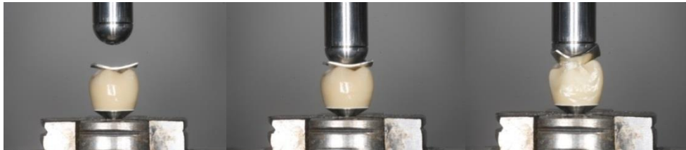
Abb. 16: Druckversuch mit kohäsivem Versagen der Verblendkeramik.
