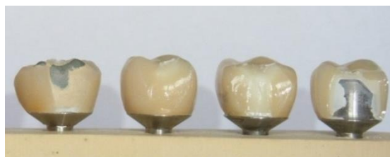
Abb. 17: Darstellung verschiedener Bruchmodi. V.l.i.n.re.: Adhäsiver Bruch CoCr-Gerüst, kohäsiver Bruch ZrO 2 -Gerüst, adhäsiver Bruch ZrO 2 -Gerüst und Totalversagen mit Bruch des ZrO 2 -Gerüsts.
