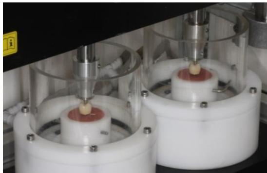
Abb. 15: Einstellung der Antagonisten vor dem Befüllen der Probenkammern mit Speichelersatzlösung.
