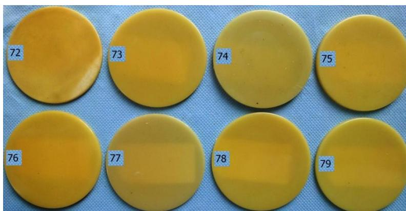
**Abb. 4.17 Ergebnisse der zweistufigen Wachsbleichung H<sub>2</sub>O<sub>2</sub> - NDC (2.St)**
