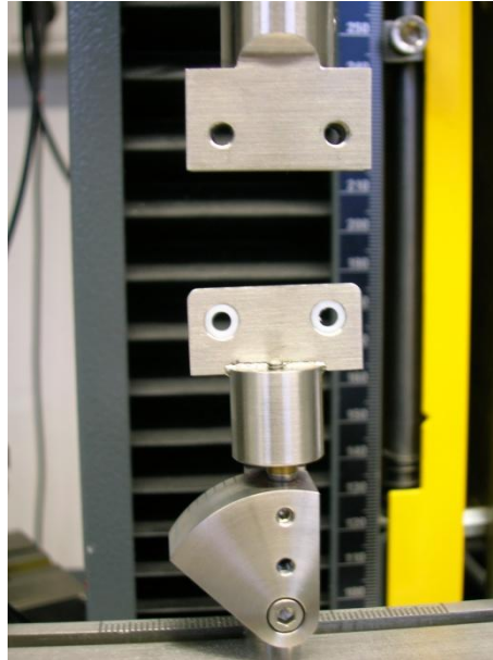
Abb. 8: Aufgesteckter Probenhalter mit Locator-Retentionseinsatz vor dem Einspannen in die Abzugsvorrichtung
