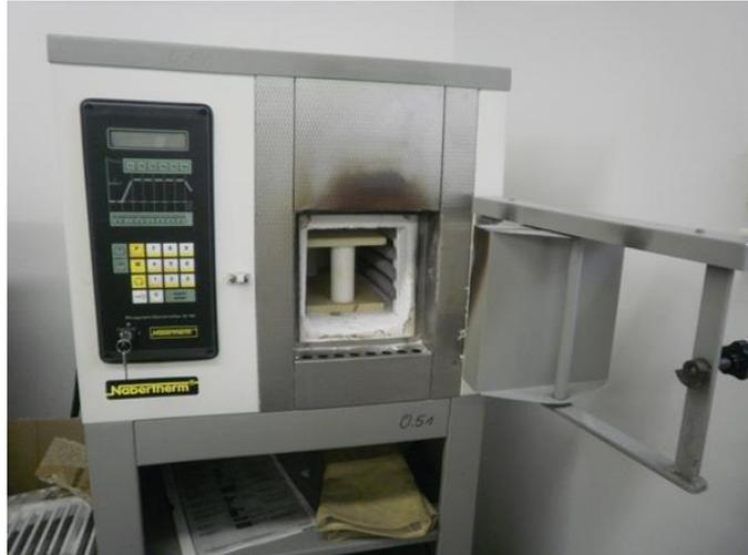
Abb. 3.5: Der verwendete elektrische Brennofen „C 19“ der Firma Nabertherm.
