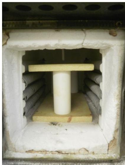
Abb. 3.7: Blick in den Laborofen mit konstruierter Brennhilfe.
