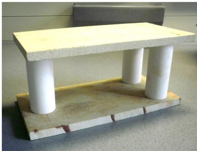
Abb. 3.6: Cordierit-Ofenplatten mit 3 Brennstützen für zweietagigen Brand.
