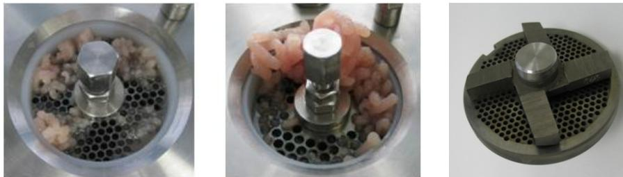
Abbildung 31: Beispielhafte Darstellung der Ausprägung einzelner Fleischzäpfchen beim Austritt aus einem 2-teiligen Schneidsatz (links und Mitte) und der durch die 4 Messerbalken beeinflussten Bohrungen (rechts: Ansicht von unten, (eigene Darstellung))
