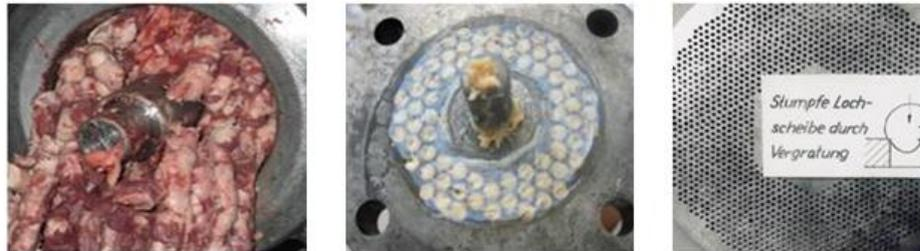
Abbildung 11: Beispielhafte Darstellung von Problemen beim Wolfen mit nicht auf den Rohstoff abgestimmter Technik (links: inhomogene Zerkleinerung und Durchmischung) oder durch ungünstige Maschineneinstellungen (Mitte: Verletzung; rechts: erhöhter Werkzeugverschleiß), (eigene Darstellung)
