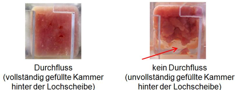
Abbildung 45: Relevante Situationen der Fleischzäpfchenbildung beim Scheren an einer Lochscheibe (eigene Darstellung)
