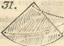
Die Logge ist das Instrument, den Gang des Schiffes zu messen. Die Einrichtung ist folgende. An ein  $\frac{1}{2}$  Zoll dickes Bret, der Form nach ein Quadrant (man sehe hier
