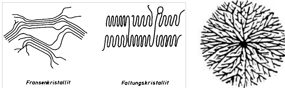
Abbildung 3.1: Mögliche Anordnungen der amorphen und semikristallinen Bereiche in Polymeren (Fransenkristallit / Faltungskristallit) 140 sowie die schematische Darstellung der Mikrostruktur in einem Sphärolithen 141
