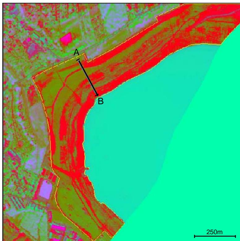
Abb. 32 RGB-Composite image aus den Abundanzen Mischsubstrat und Grasansaat sowie dem Modellierungsfehler
