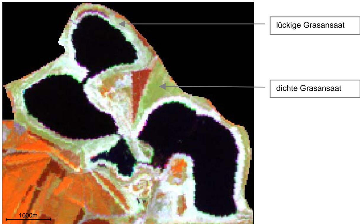
Abb. 28 Darstellung von Ansaatflächen im Landsat7 ETM-Datensatz vom 14.08.2000 (Restlöcher Niemeck und Mühlbeck; Kanalkombination 4/5/3 in r/g/b)
