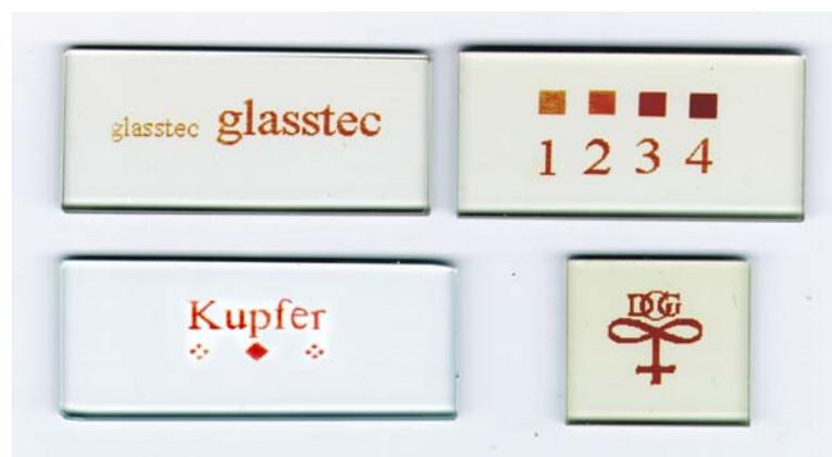
**Abbildung 4.28.:** Durch CO<sub>2</sub>-Laserbestrahlung erzeugte Farbstrukturen in ionenausgetauschtem Floatglas. Originalbreite der Glasstreifen : 20 mm
